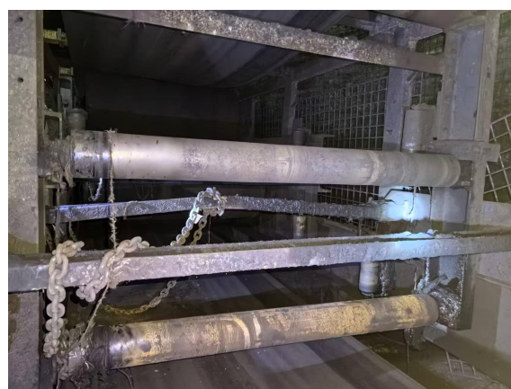
图4 拖带小车侧圆环链缠绕情况
