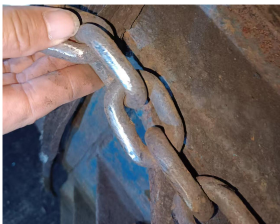
图3 张紧小车侧圆环链摩擦痕迹
