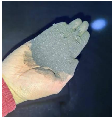
图 2 现场实拍喷出煤渣
